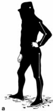
Εικόνα 2(a-c): (2a) Ένδυση εξεταζόμενων με μαύρο χρώμα και ανακλαστήρες (2b) Φωτογραφική μηχανή τοποθετημένη σε τροχούς (2c) Διάγραμμα που προέρχεται από τις φωτογραφίες του Marey.
