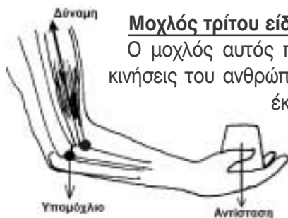
Σχ. 1. 15. Παράδειγμα μοχλού τρίτου είδους.
