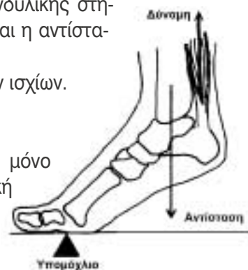
Σχ. 1. 14. Παράδειγμα μοχλού δευτέρου είδους.
